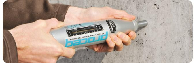
**Type N/L:** la référence pour tous les scléromètres à rebond et la base pour la définition de chaque norme internationale sur les scléromètres à rebond. Disponible avec différentes énergies d'impact pour permettre aux clients de tester un large choix de matériaux et de types de structures.
