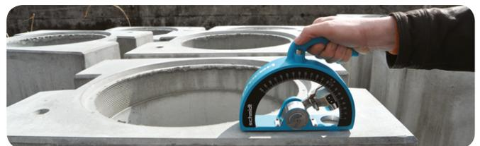
**Type PT:** équipé d'une tige de percussion ayant une plus grande surface, il est spécifiquement conçu pour les tests sur des matériaux plus souples comme le béton léger, les plaques de plâtre et le béton frais. Il est souvent utilisé pour déterminer le moment où retirer le coffrage.
