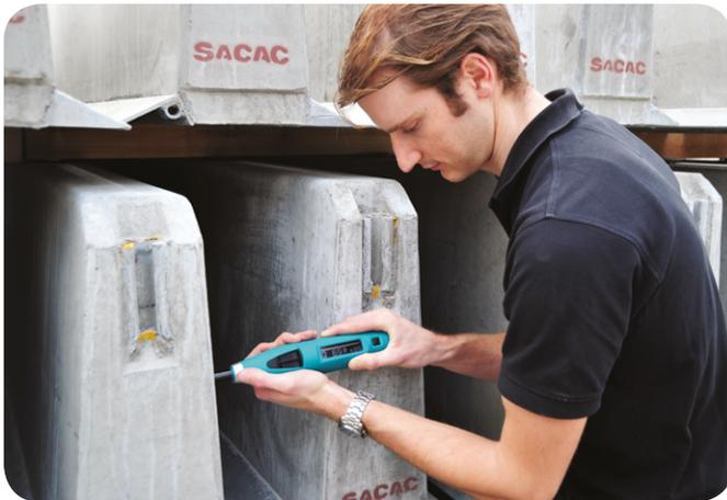
**ST/PC type N/L:** le scléromètre à rebond le plus sophistiqué du marché, avec des caractéristiques de dispersion, de durabilité, et une plage de mesure inégalées.
