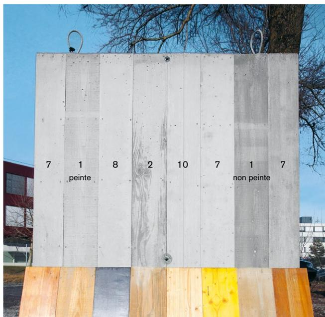
Le bullage et les variations de teintes sont moins prononcés sur une peau de coffrage (structurée (texturée)) que sur la surface d'une peau de coffrage non texturée.
