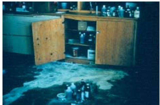
35/3 Dans ce laboratoire, des verres remplis de produits chimiques, qui n'étaient pas retenus par des dispositifs adéquats, se sont brisés en tombant de la table et des buffets ouverts (San Fernando, Californie).
